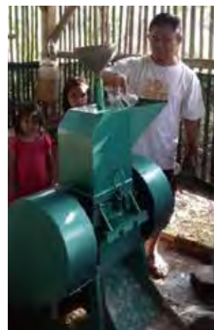
プラスチックを砕く 機械を使用する様子
